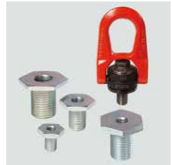
Gewintheadapter können beispielsweise verwendet werden, wenn ein zu großes, vorhandenes Gewindebohrloch genutzt werden soll
