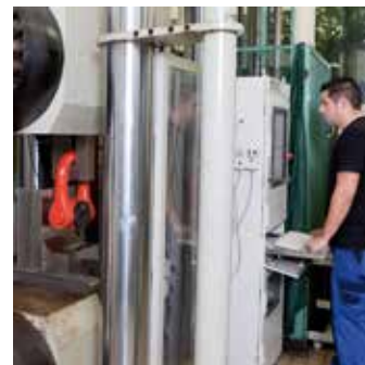
Prüfung eines Sonder- anschlagpunktes nach Maschinenrichtlinie
