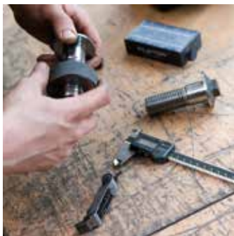
Fertigung eines Sonder- anschlagpunktes nach Maschinenrichtlinie
