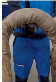
Abb. 14: Rundschlinge mit einsatzbedingter Verdickung
