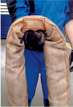
Abb. 12: Rundschlinge mit fertigungsbedingter Verdickung
