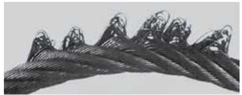
Abb. 13: Schlaufenbildung an einem Drahtseil
