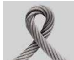
Abb. 17: Durch Zuziehen einer Seilschlinge eingestandene Klanke
