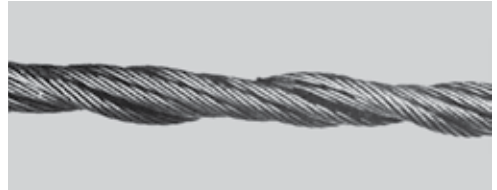
Abb. 14: Durch Abrostung und Abrieb stark gelockerte Litze
