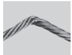
Abb. 18: Durch mechanische Einwirkung entstandener Knick
