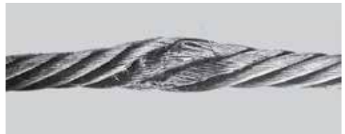
Abb. 16: Durch Überfahren abgeplattetes Drahtseil
