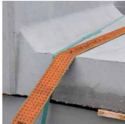
Kanten gelten als scharf, wenn der Kantenradius  $R$  der Last kleiner ist als die Dicke des Hebebandes oder der Rundschlinge
