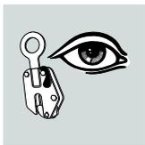
Vor jedem Gebrauch die Klemme auf Funktionsfähigkeit, Beschädigungen und Verschleiß überprüfen. Nie beschädigte, überlastete oder abgenutzte Klemmen einsetzen. Klemmen im Abstand von längstens einem Jahr von einem Sachkundigen prüfen lassen.
