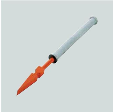
In Stapeln gelagerte Bleche lassen sich mit dem Stoßkeil schnell, einfach und sicher zum Anschlagen anheben, Bestell-Nr. 121977
